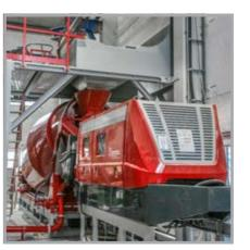
Der Pufferspeicher kann direkt unter der Mischanlage platziert oder über eine vorhandene Kübelbahn befüllt werden.
