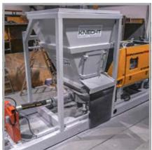
Bei kleinen Fertigteilen oder kleinen Mischanlagen genügt eine Trichtererhöhung, um die kontinuierliche Versorgung der Betonpumpe mit Beton zu gewährleisten.
