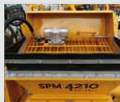
5 Бункер, спроектированный для торкрет-бетона
