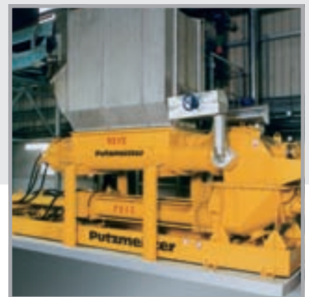
Завод по переработке биологических отходов в г. Варен-Жарси, Франция: поршневой насос KOS 2180 перекачивает биомассу в установку для брожения
