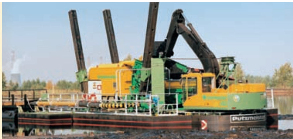
Удаление шлама на месторождении смолы с помощью карabelьного экскаватора с дистанционным управлением фирмы «Dredgemaster»
