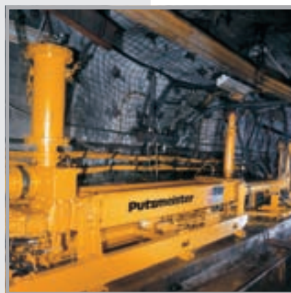
Установка подъема шлама HBL. Старая: 43 центробежных насоса. Новая: 2 шламовых насоса HSP 3080.
