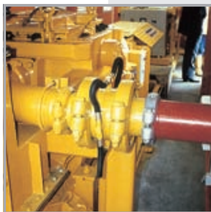
Вверху: Дозатор смазки для улучшения скольжения Внизу: Место введения смазки
