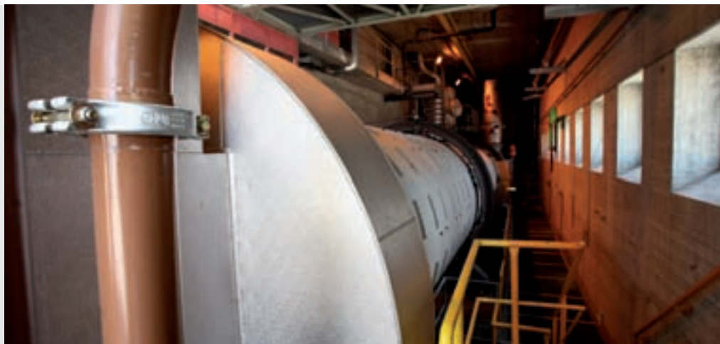
Очистная установка в г. Офtringен, Швейцария: вращающаяся трубчатая печь для сжигания шлама очистных сооружений
