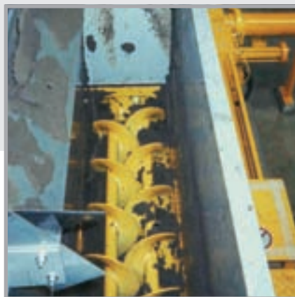
Сдвоенные подпрессовочные шнеки со смесительными лопастями в подводящей шахте
