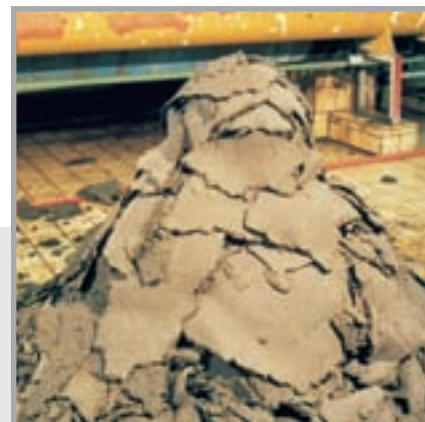
Шлам очистных сооружений, обезвоженный с помощью ленточного сеточного прессования: содержание сухих веществ > 35 %
