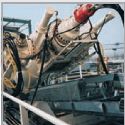
Шнековый транспортёр с двумя насосами для отходов породы типа KOS 1480, туннель Botlek
