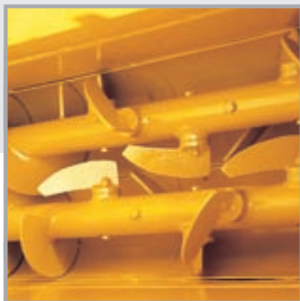
Сдвоенные подпрессовочные шнеки со смесительными лопастями в подводящей шахте
