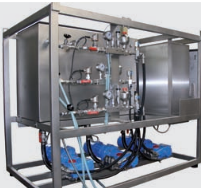
Вверху: Дозатор смазки для улучшения скольжения Внизу: Место введения смазки
